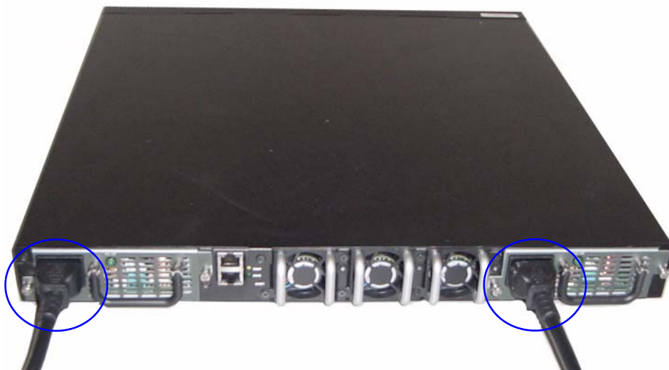
図 2 電源ケーブルの接続
