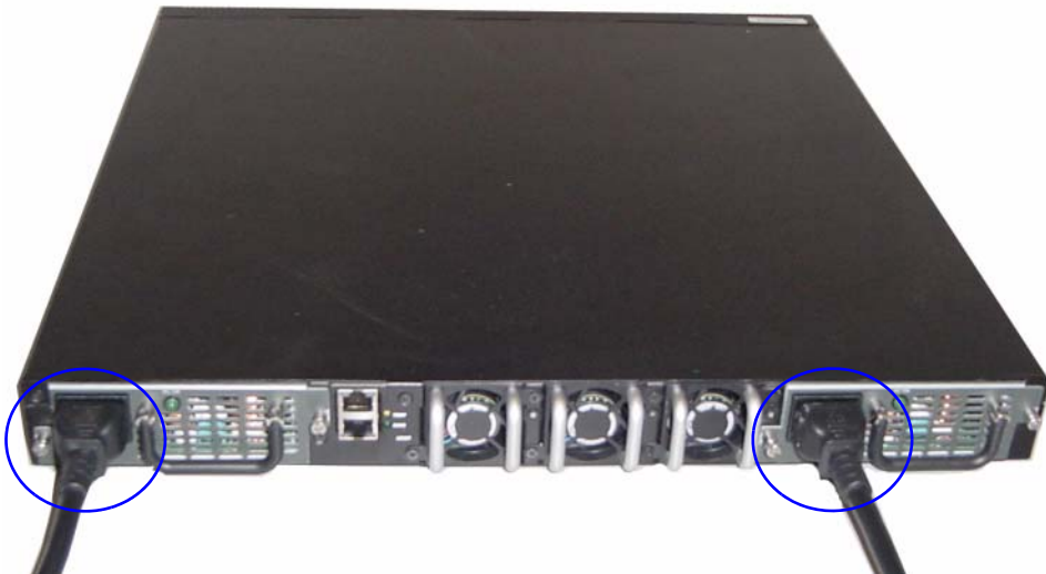
Ilustración 2. Conexión de los cables de alimentación
